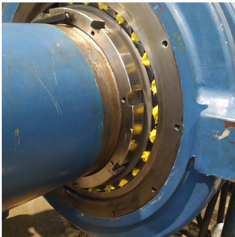
Galgado de juego radial según norma de rodamiento
