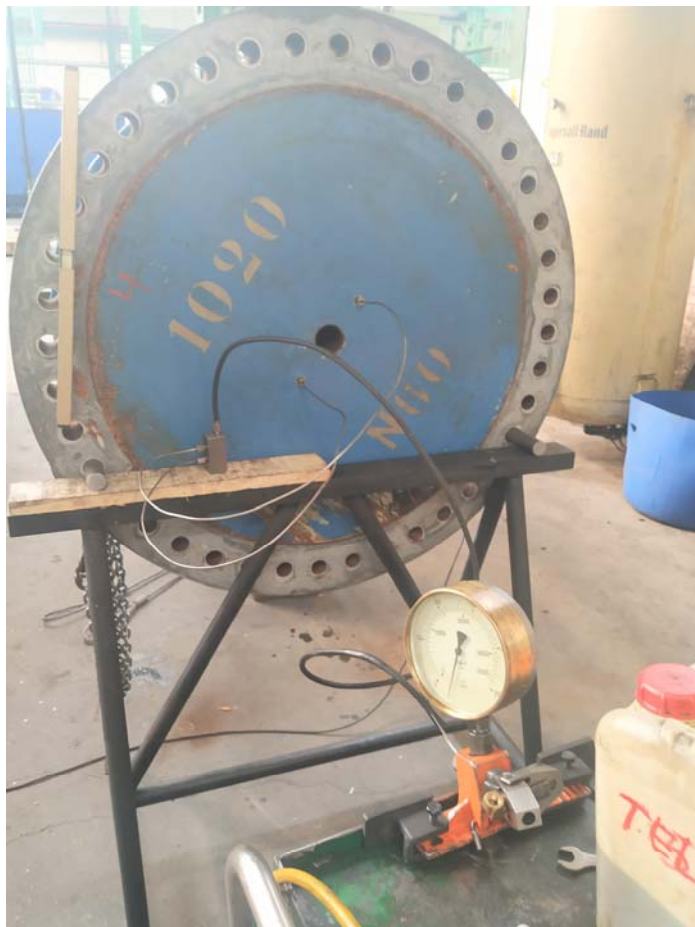
Montaje del rodamiento con sistema hidráulico
