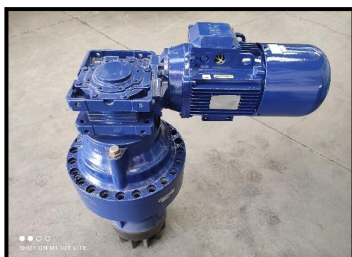
Fig. 17. Acabado Final Motor & Reductora.
