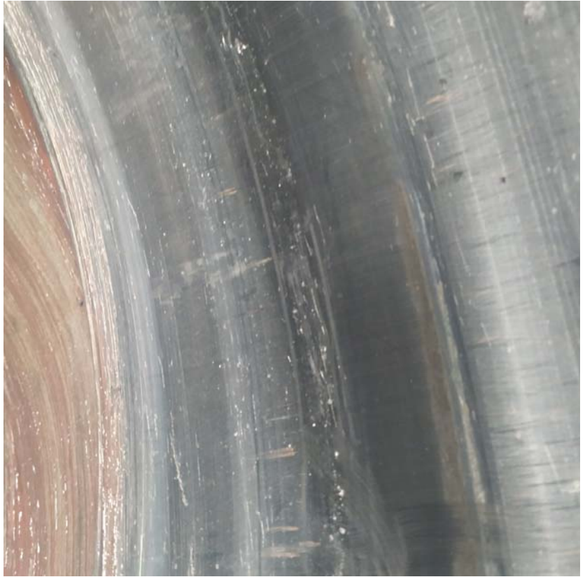
Alojamiento del lado contrario al buje portapalpas. Necesario encasquillar.
