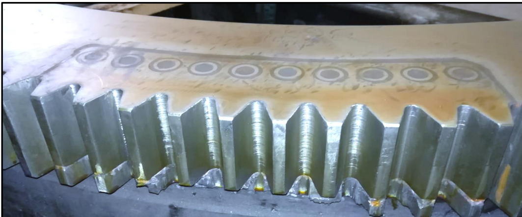
Estado final de la reparación, inserto 1
