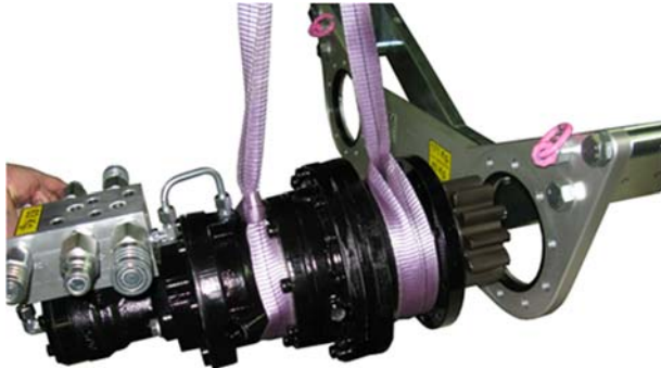
Ensamblar reductor inferior.
