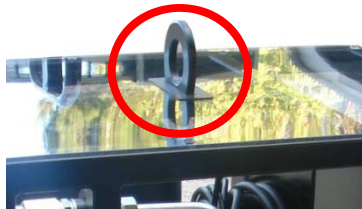
Gancho de izado de la Central.
