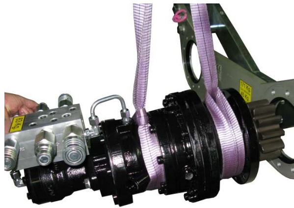
Ahorcado doble del reductor en el interior de la nacelle.
