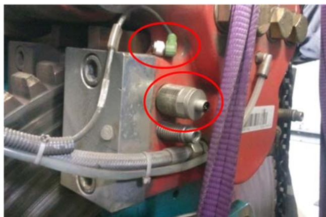
Desconectar sensor pinza de freno.
